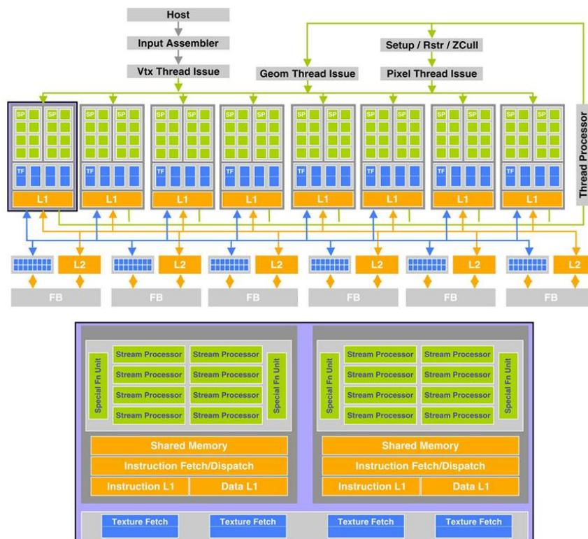
Figura 1-2: Ejemplo de arquitectura de la GPU de la tarjeta gráfica de Nvidia GeForce 8800 GTX
