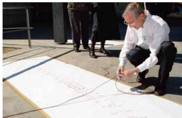
Figura 1. Marcando en un pliego sobre el suelo la posición de la sombra del gnomón (comenzamos a medir a las 12:00 h. y terminamos a las 15:00 h.).
