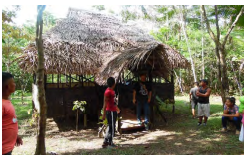
Figura 3. Ejemplo de uso de hoja de palma en construcción indígena en el Amazonas
