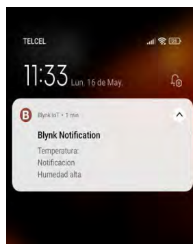
Figura 10. Notificación que envía Blynk a dispositivo móvil cuando la humedad esta fuera de rango y afecta al producto
