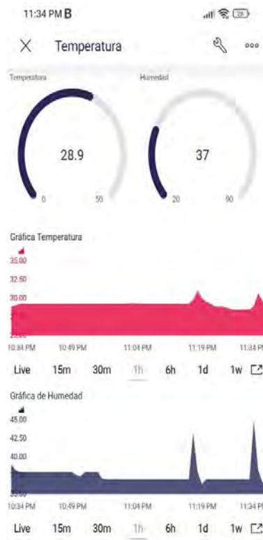
Figura 8. Datos que son enviados por el sensor a un dispositivo móvil
