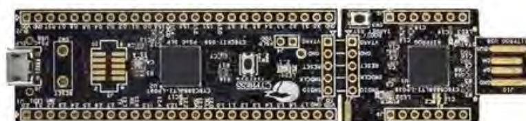
Figura 2. Sistema de prototipado rápido CY8CKIT-059 con el microcontrolador C8C5888LTI-LP097 el cual fue implementado como sistema de acondicionamiento. Sus componentes analógicos y digitales programables brindan la versatilidad necesaria al sistema para ser modular y reconfigurable
