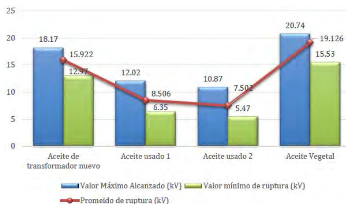
Figura 12. Gráfica de valores promedio vs valores máximos y mínimos basados en el estándar ASTM D877
