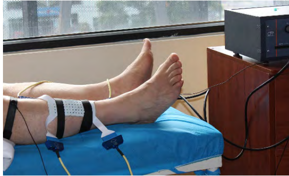
Figura 5. Localización de instrumentación en el músculo tibial anterior [13]
