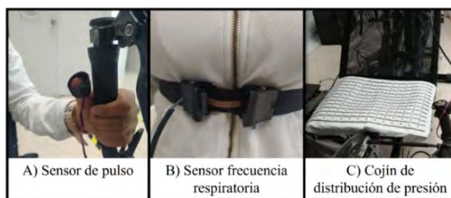
Figura 13. Sensores acoplados al triciclo: A) Sensor de pulso en el dedo pulgar de la mano izquierda y ubicado en el manubrio. B) Sensor de frecuencia respiratoria ubicado debajo del pecho. C) Cojín de distribución de presión en el asiento del triciclo
