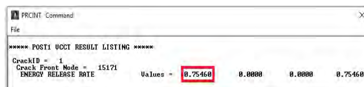
Figura 6. Resultado de K_I obtenido numéricamente para una longitud de grieta a = 5\text{ mm}
