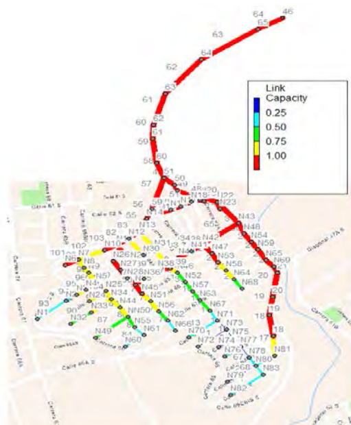
Figura 9. Reflujo red de alcantarillado pluvial caso 3
