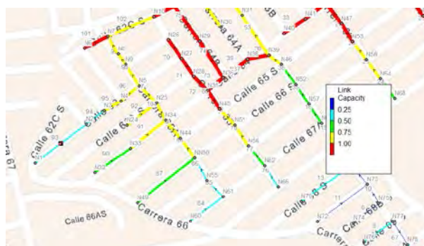
Figura 11. Condiciones críticas de la red de alcantarillado pluvial del barrio Isla del Sol para el caso 3
