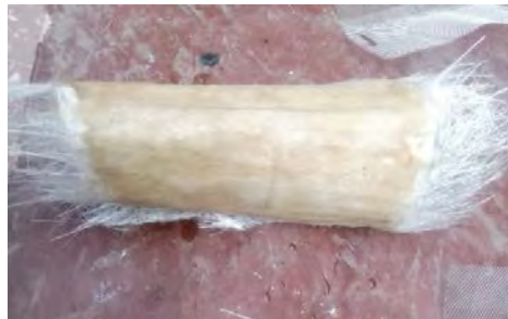
Figura 10. Conformado por capas de fibra de vidrio
