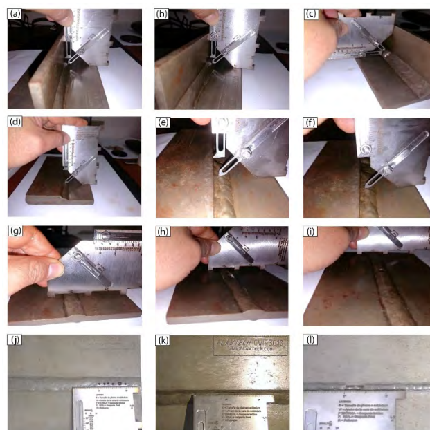
Figura 14. Disposición de dispositivo de utilidad para dimensionar el tamaño de: (a, b, c) pierna y garganta simultáneamente en junta en T, (d, e, f) garganta en junta de solape, (g, h, i) refuerzo en junta a tope, y (j, k, l) discontinuidades superficiales
