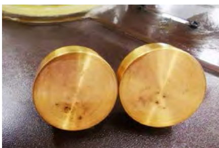
Figura 3. Electrodos construidos bajo las especificaciones del estándar ASTM D877
