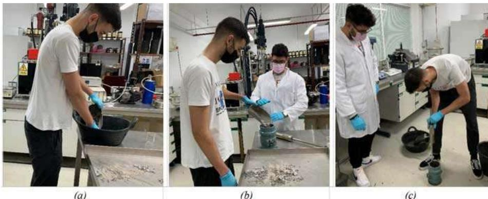
*Figura 1. Estudiante colaborando en las distintas etapas del ensayo Proctor Normal bajo la supervisión del docente Pablo Orosa: (a) mezclado de muestra de suelo con distintos contenidos de agua; (b) introducción de la primera capa de muestra en molde; (c) compactación de la muestra con ayuda de la maza*
