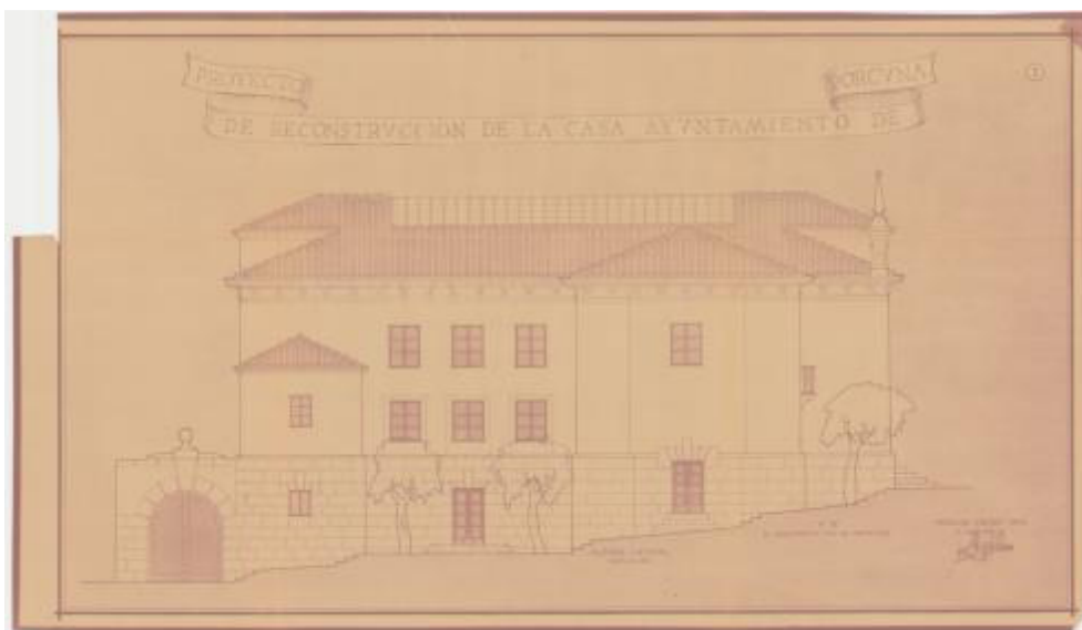
Fachada lateral de la nueva construcción en la que se observa como el arquitecto busca la línea de las escaleras principales para convertirlas en podio. Archivo General de la Administración. TOP-76-13-CA-20361
