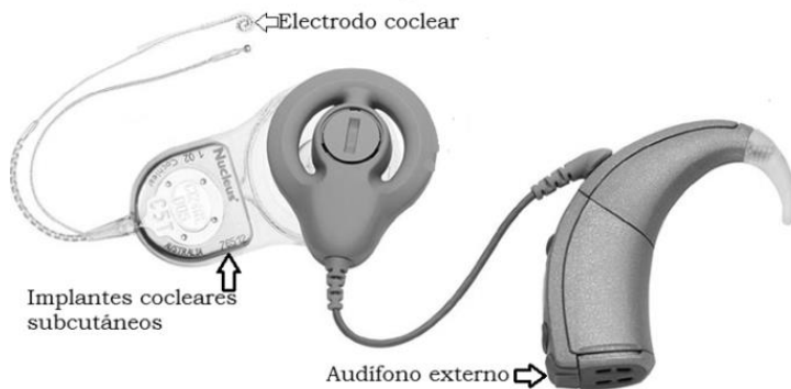
Figura 1. Imágenes reales de las partes internas y externas de un IC. Tomado de www.elbauradiologico.com
