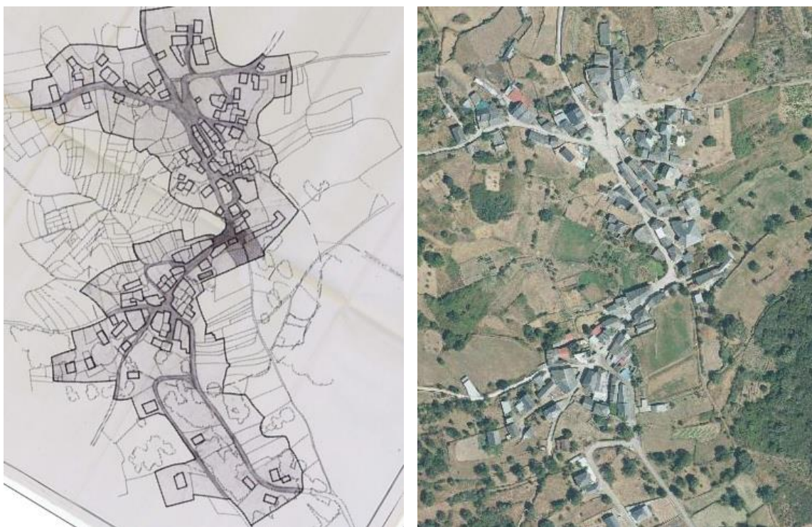
Figura 11. Izquierda: Delimitación y ordenación del Núcleo Rural de Langullo. Derecha: Vista aérea de Langullo. Fuente: Izquierda: POMR de Manzaneda de 2003. SIOTUGA. Derecha: Vuelo PNOA 2020, CNIG.
