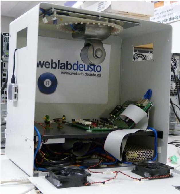
Figure 7. WebLab-DEUSTO-PIC para el módulo de microcontroladores
