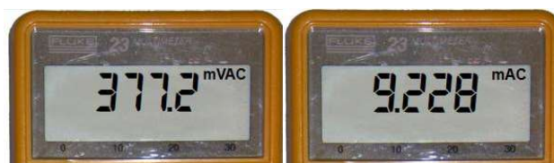
Fig. 12. Medidas de corriente y tensión en el condensador de un RL
