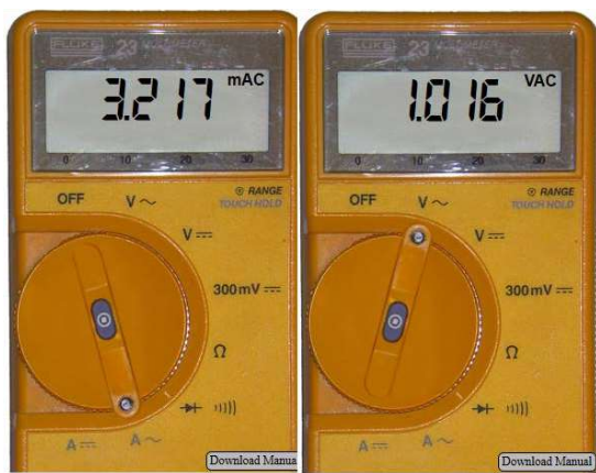
Fig. 11. Medidas de corriente y tensión en el condensador de un RC
