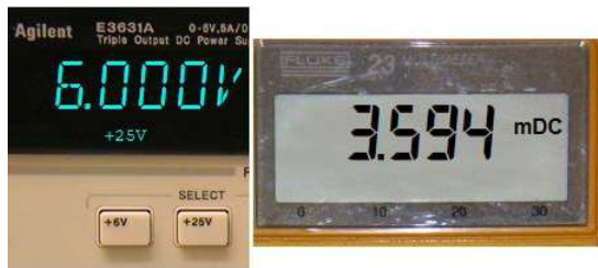
Fig. 3. Fuente de alimentación y multímetro de VISIR
