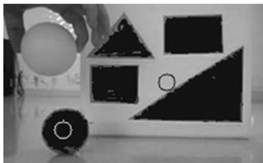
Figura 4. Con círculo rojo, el centroide usando sólo el filtro de color y con círculo verde, el centroide usando el filtro de color y el detector de circularidad.
