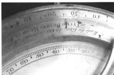
Figura nº 18A. *Detalle de compás azimutal de G. Adams. S. XVIII. N° inv. 85/4/357*
